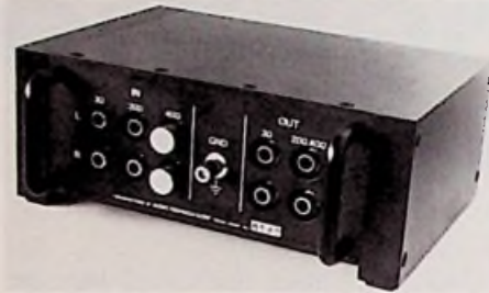
Bild 4: AT 1000 T, ein 8 kg schwerer Anpaß-Übertrager
